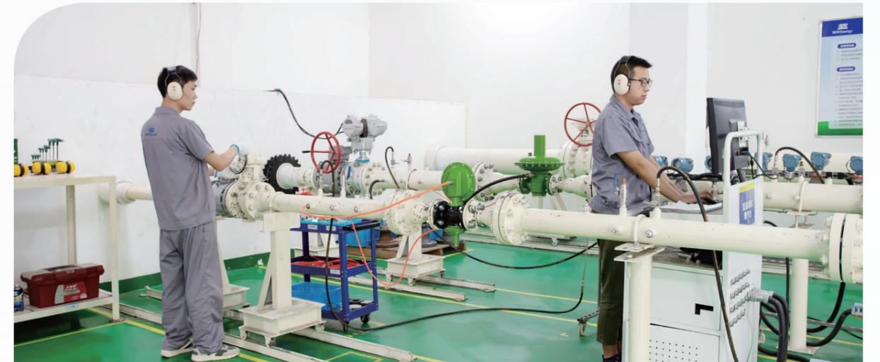
CNAS 流量实验室配有 1" /2" /4" /12" 四条流量测试线，可进行静特性、流量系数、高温及耐久等性能测试。可测试最大进口压力 5MPa，最大口径 DN300，最大测试流量 10000Nm<sup>3</sup>/h 的调压器。
